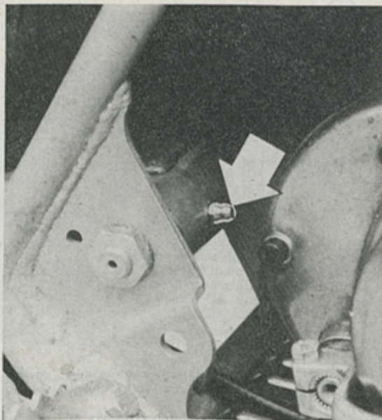
Graisseur pour la lubrification de l'axe du bras oscillant des Sherpa T 250 et 350. (Photo RMT).
